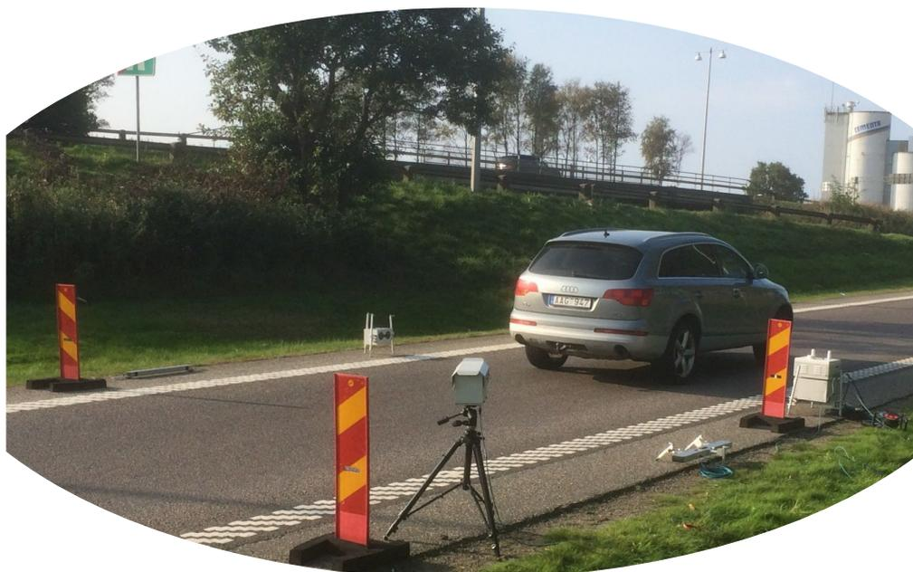
**Figura 3 – Instalação típica de equipamentos de Sensoriamento Remoto**
