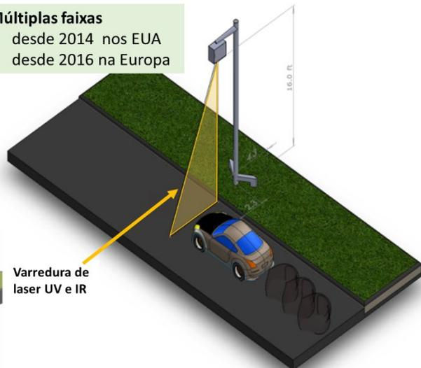
**Figura 2 –Sensoriamento Remoto para todos os poluentes em qualquer veículo**
